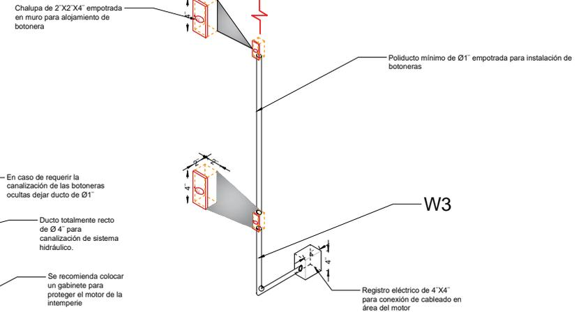
\*Tubería y registro eléctricos suministrados por el cliente, únicamente ductería sin cableado (DEJAR GUIADO CANALIZACIÓN)
