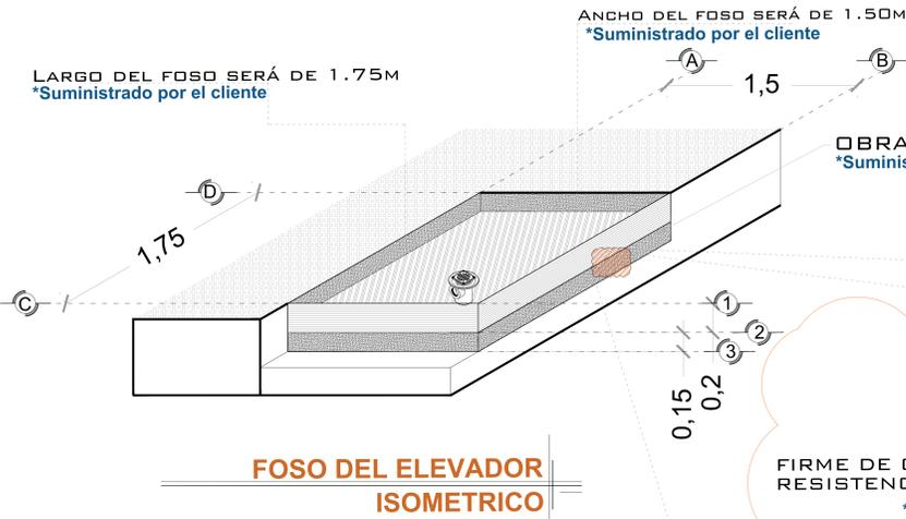
OBRA CIVIL PARA EL ANCLAJE DEL EQUIPO
