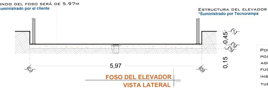
POR MOTIVO DE SEGURIDAD ANTE POSIBLES ACUMULACIONES DE AGUA, COMO INUNDACIONES O FUGAS, SE RECOMIENDA LA INSTALACIÓN UNA SALIDA DE TUBERÍA DE DRENAJE (COLADERA) PARA DESALOJAR EL AGUA QUE SE PUDIERA ALMACENAR EN EL FOSO, DICHA TUBERÍA SE CONECTARA A LA RED DE DRENAJE O ÁREAS VERDES SEGÚN LA DECISIÓN DEL CLIENTE.
