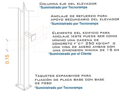
EL MURO DEBERÁ DE SOPORTAR Y DAR FIRMEZA A LA ESTRUCTURA DEL ELEVADOR. SE REQUIERE QUE EL ÁREA DONDE SE COLOQUEN LOS SOPORTES SEA UN MURO COMPLETO DE CONCRETO SI NO ES ASÍ, EL ÁREA DE CONEXIÓN DEBERÁ DE SERLO EMPLEÁNDOSE PARA ELLO UNA TRABE O CADENA DE CERRAMIENTO REFORZADA CON UN PERALTE MÍNIMO DE 15CM.
