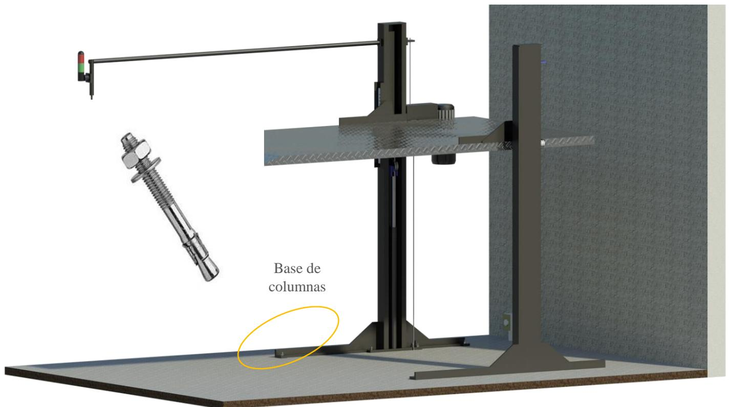
Para la correcta instalación del equipo, es necesario que la base del concreto sea armado con malla electrosoldada 66.10.10, donde se deberá de utilizar concreto con una resistencia de  $f''c=250 \text{ kg/cm}^2$  y un espesor de 0.15 m
