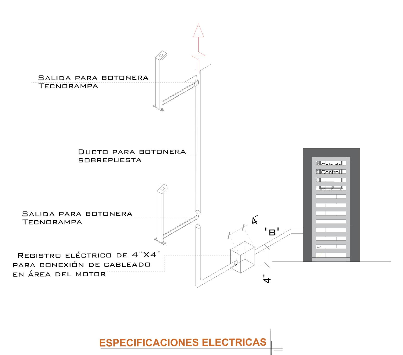
LA DISTANCIA "B" SE CUBRIRÁ DE SER POSIBLE CON DUCTOS REALIZADOS CON TUBERÍA Y LA SALIDA EN EL FOSO SERÁ RECOMENDABLE UBICARLA DEL LADO DONDE SE ENCONTRARAN LAS COLUMNAS Y EL RESTO DE LA ESTRUCTURA DEL ELEVADOR. EN CASO DE QUE NO SE PUEDA INSTALAR ESTOS DUCTOS SE EMPLEARA UNA CANALIZACIÓN DIFERENTE QUE PROTEJA EL CABLEADO. EN CUALQUIERA DE LOS DOS CASOS ESTÁ SERÁ SUMINISTRADA POR PARTE DE TECNORAMPA Y LOS TRABAJOS PARA SU INSTALACIÓN LO HARÁ EL EQUIPO DE LA EMPRESA.
