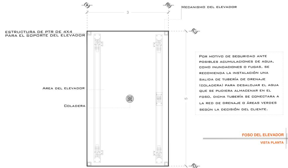
POR MOTIVO DE SEGURIDAD ANTE POSIBLES ACUMULACIONES DE AGUA, COMO INUNDACIONES O FUGAS, SE RECOMIENDA LA INSTALACIÓN UNA SALIDA DE TUBERÍA DE DRENAJE (COLADERA) PARA DESALOJAR EL AGUA QUE SE PUDIERA ALMACENAR EN EL FOSO, DICHA TUBERÍA SE CONECTARA A LA RED DE DRENAJE O ÁREAS VERDES SEGÚN LA DECISIÓN DEL CLIENTE.
