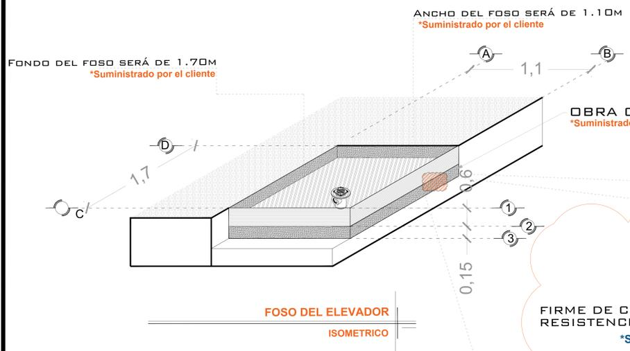
OBRA CIVIL PARA EL ANCLAJE DEL EQUIPO
