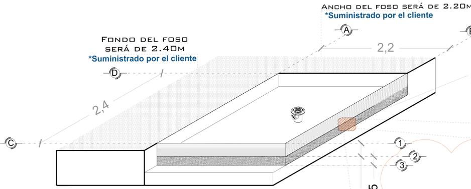
OBRA CIVIL PARA EL ANCLAJE DEL EQUIPO
