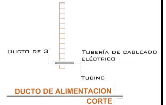
LA DISTANCIA "B" SE CUBRIRÁ DE SER POSIBLE CON DUCTOS REALIZADOS CON TUBERÍA Y LA SALIDA EN EL FOSO SERÁ RECOMENDABLE UBICARLA DEL LADO DONDE SE ENCONTRARAN LAS COLUMNAS Y EL RESTO DE LA ESTRUCTURA DEL ELEVADOR. EN CASO DE QUE NO SE PUEDA INSTALAR ESTOS DUCTOS SE EMPLEARÁ UNA CANALIZACIÓN DIFERENTE QUE PROTEJA EL CABLEADO. EN CUALQUIERA DE LOS DOS CASOS ESTÁ SERÁ SUMINISTRADA POR PARTE DE TECNORAMPA Y LOS TRABAJOS PARA SU INSTALACIÓN LO HARÁ EL EQUIPO DE LA EMPRESA.
