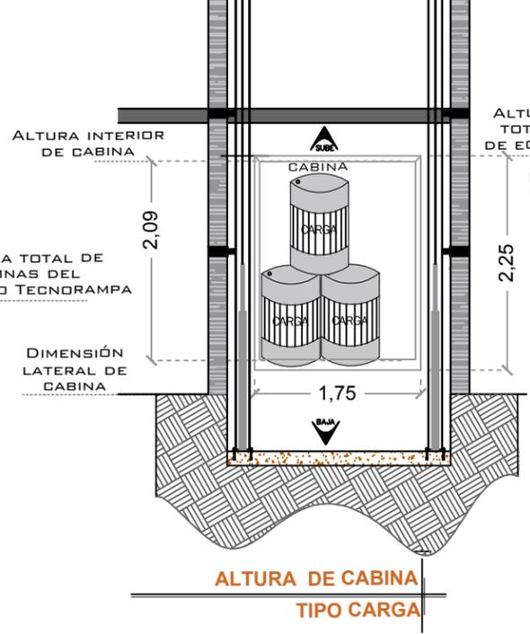
EL EQUIPO INCLUYE 3 GUILLOTINAS, 1 INTERIOR, EL ACABADO ES TIPO ELEVADOR DE AUTOS TIPO PLATAFORMA EN COLOR AMARILLO Y VIAJA CON LA CABINA Y 2 EXTERIORES DE PROTECCIÓN, INSTALADAS UNA EN CADA ESTACIÓN ES EN ALOCUBOND TIPO VOX EVOLUTION. LAS 3 GUILLOTINAS DEBERÁN, TENER UNA ALTURA DE 1.00M Y SU APERTURA ES MANUAL POR MEDIO DE UNA ESLINGA.
