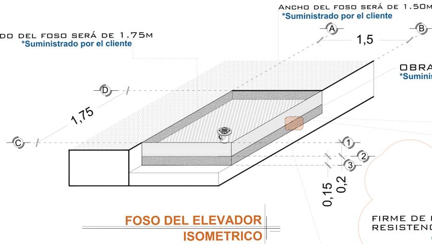
OBRA CIVIL PARA EL ANCLAJE DEL EQUIPO
