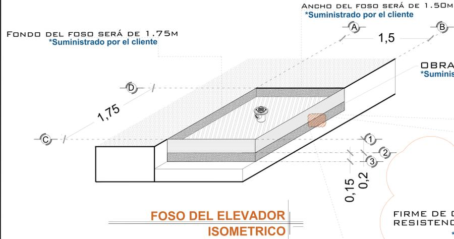
OBRA CIVIL PARA EL ANCLAJE DEL EQUIPO
