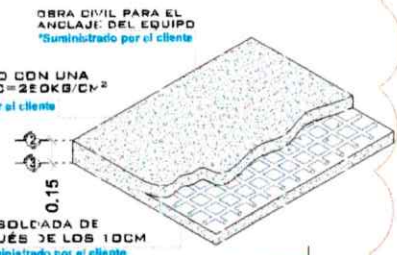
ARMADO DE FIRME ISOMETRICO
