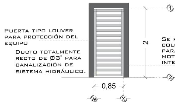
DUCTO TOTALMENTE RECTO DE Ø3" PARA CANALIZACIÓN DE SISTEMA HIDRÁULICO.
