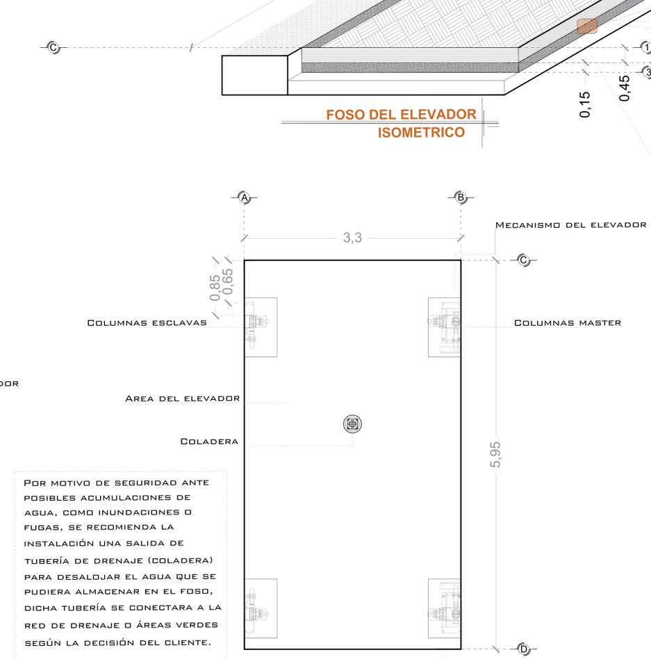
POR MOTIVO DE SEGURIDAD ANTE POSIBLES ACUMULACIONES DE AGUA, COMO INUNDACIONES O FUGAS, SE RECOMIENDA LA INSTALACIÓN UNA SALIDA DE TUBERÍA DE DRENAJE (COLADERA) PARA DESALOJAR EL AGUA QUE SE PUDIERA ALMACENAR EN EL FOSO, DICHA TUBERÍA SE CONECTARA A LA RED DE DRENAJE O ÁREAS VERDES SEGÚN LA DECISIÓN DEL CLIENTE.
