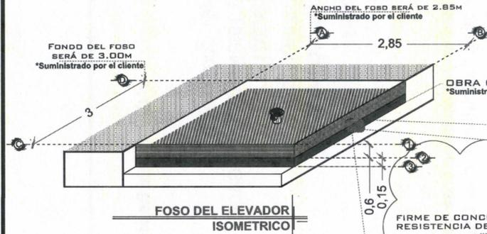
OBRA CIVIL PARA EL ANCLAJE DEL EQUIPO
