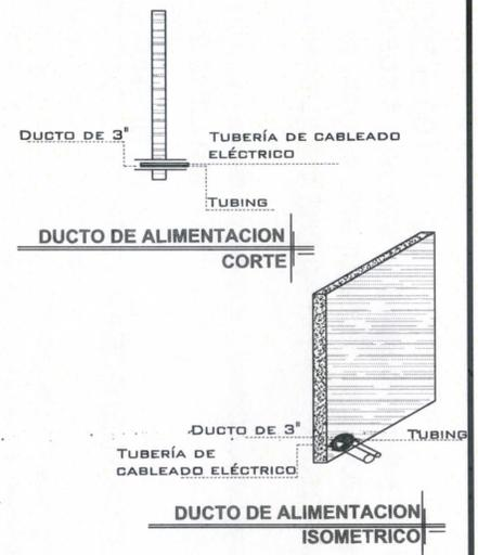
LA DISTANCIA "B" SE CUBRIRÁ DE SER POSIBLE CON DUCTOS REALIZADOS CON TUBERÍA Y LA SALIDA EN EL FOSO SERÁ RECOMENDABLE UBICARLA DEL LADO DONDE SE ENCONTRARAN LAS COLUMNAS Y EL RESTO DE LA ESTRUCTURA DEL ELEVADOR. EN CASO DE QUE NO SE PUEDA INSTALAR ESTOS DUCTOS SE EMPLEARÁ UNA CANALIZACIÓN DIFERENTE QUE PROTEJA EL CABLEADO. EN CUALQUIERA DE LOS DOS CASOS ESTÁ SERÁ SUMINISTRADA POR PARTE DE TECNORAMPA Y LOS TRABAJOS PARA SU INSTALACIÓN LO HARÁ EL EQUIPO DE LA EMPRESA.
