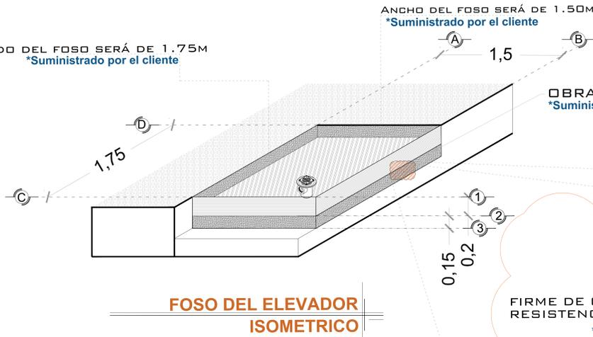
OBRA CIVIL PARA EL ANCLAJE DEL EQUIPO
