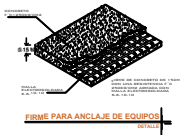
REJES PARA ANCLAJE DE EQUIPOS
