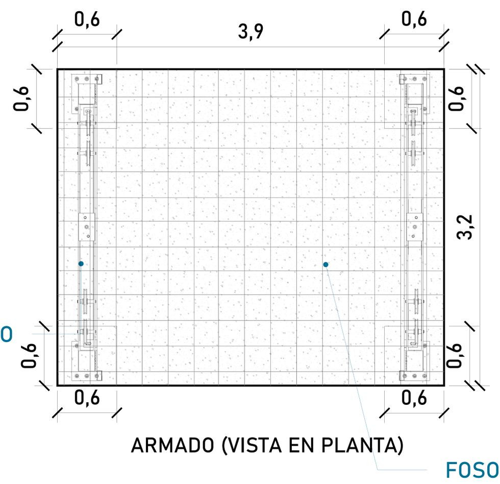
Se requiere una Placa de  $\frac{5}{8}$ " de 0.60m x 0.60m, para la instalación del elevador de carga
