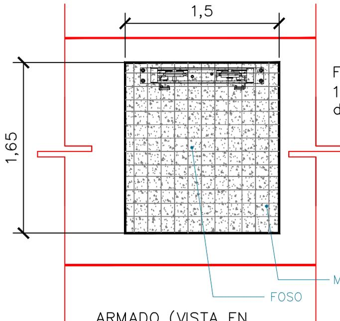
Firme de concreto armado, mínimo 15cm de espesor y F'c= 250 kg/cm<sup>2</sup> de resistencia
