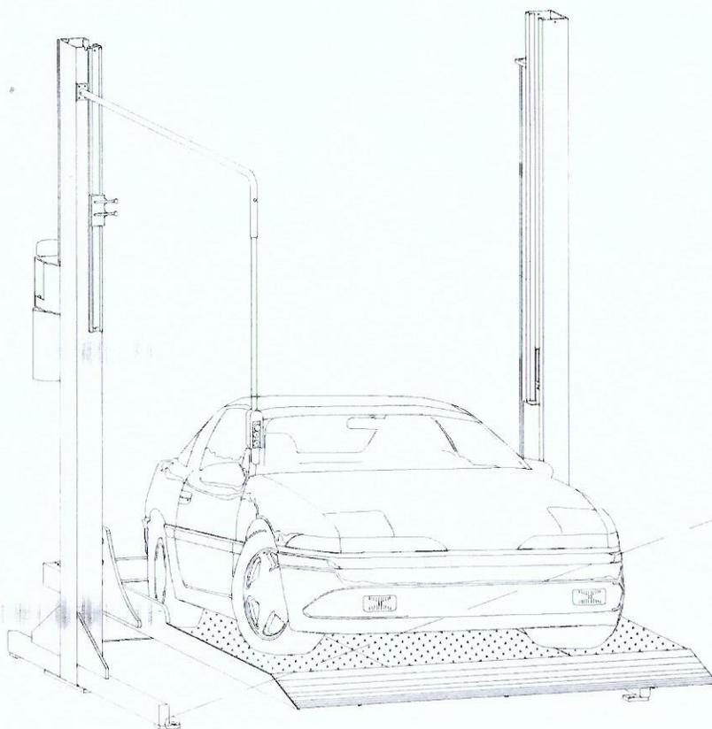
LAS RAMPAS TR EVOLUTION VAN ANCLADAS EN LA BASE DE COLUMNAS POR MEDIO DE TAQUETES EXPANSIVOS PUNTA ARPÓN DE  $\frac{3}{4}$ " DE ANCHO, POR 5" DE LARGO AL FIRME DE CONCRETO DONDE SE APOYA LA RAMPA LOS CUALES SON COLOCADOS POR EL PERSONAL DE INSTALACIÓN Y BRINDAN EL SUFICIENTE ANCLAJE PARA DARLE ESTABILIDAD A TODO EL EQUIPO.
