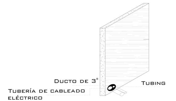
LA DISTANCIA "B" SE CUBRIRÁ DE SER POSIBLE CON DUCTOS REALIZADOS CON TUBERÍA Y LA SALIDA EN EL FOSO SERÁ RECOMENDABLE UBICARLA DEL LADO DONDE SE ENCONTRARAN LAS COLUMNAS Y EL RESTO DE LA ESTRUCTURA DEL ELEVADOR. EN CASO DE QUE NO SE PUEDA INSTALAR ESTOS DUCTOS SE EMPLEARA UNA CANALIZACIÓN DIFERENTE QUE PROTEJA EL CABLEADO. EN CUALQUIERA DE LOS DOS CASOS ESTÁ SERÁ SUMINISTRADA POR PARTE DE TECNORAMPA Y LOS TRABAJOS PARA SU INSTALACIÓN LO HARÁ EL EQUIPO DE LA EMPRESA.
