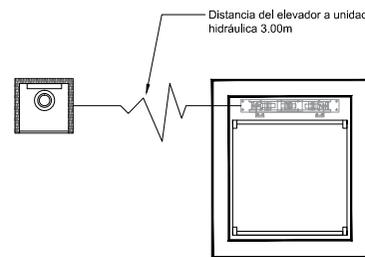
**NOTA:** Por cada nivel adicional deberá colocar una chalupa para alojar el botón de llamado y debería de continuar la tubería hasta esta.
