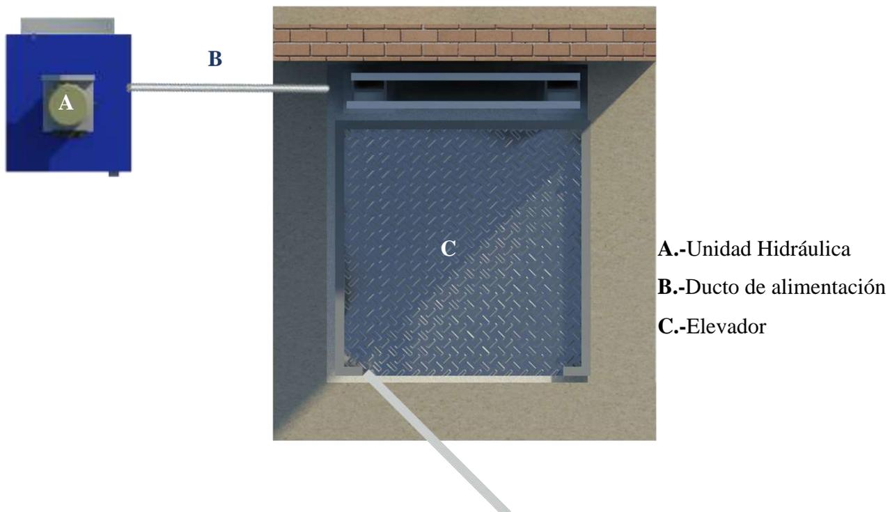
**NOTA:** La distancia B se cubrirá de ser posible con ductos realizados con tubería, y la salida en el foso será recomendable ubicarla del lado donde se encontraran las columnas y el resto de la estructura del elevador. En caso de que no se pueda instalar estos ductos se empleara una canalización diferente que proteja el cableado. En cualquiera de los dos casos esta será suministrada por parte de Tecnorampa, y los trabajos para su instalación lo hará el equipo de la empresa.
