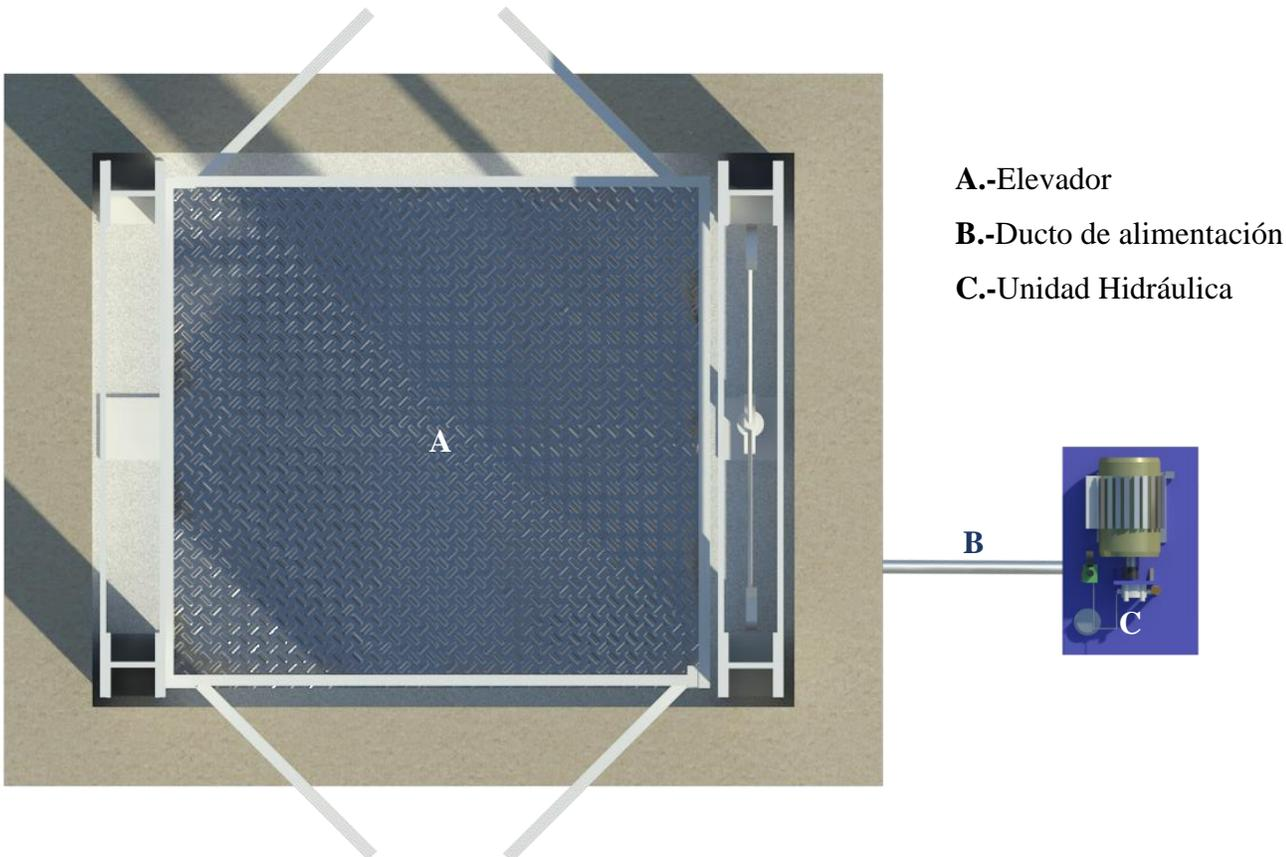
**NOTA:** La distancia B se cubrirá de ser posible con ductos realizados con tubería, y la salida en el foso será recomendable ubicarla del lado donde se encontraran las columnas y el resto de la estructura del elevador. En caso de que no se pueda instalar estos ductos se empleara una canalización diferente que proteja el cableado. En cualquiera de los dos casos esta será suministrada por parte de Tecnorampa, y los trabajos para su instalación lo hará el equipo de la empresa.
