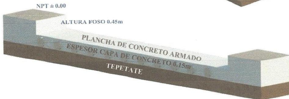
Se recomienda el uso de concreto con una resistencia mínima de  $f'c=250\text{kg/cm}^2$  armado con malla electro soldada 6.6 10.10 delgada después de los primeros 10cm para el mejor anclaje del equipo, a lo largo y ancho del área de instalación
