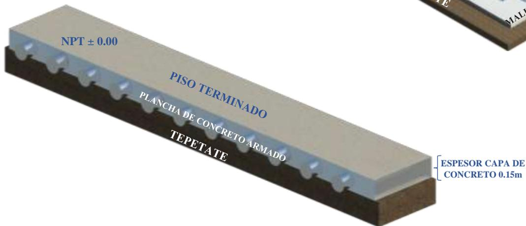
Se recomienda el uso de concreto con una resistencia mínima de  $f'c=250\text{kg/cm}^2$  armado con malla electro soldada 6.6 10.10 delgada después de los primeros 10cm para el mejor anclaje del equipo, a lo largo y ancho del área de instalación
