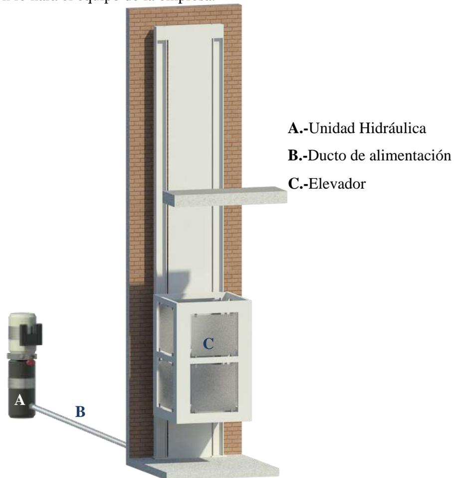
La unidad hidráulica y control eléctrico deberán ser instalados fuera del foso y ubicarse en un lugar libre de polvo, líquidos e inclemencias del clima, evitando que se contamine el aceite y se pierda la garantía del equipo.
