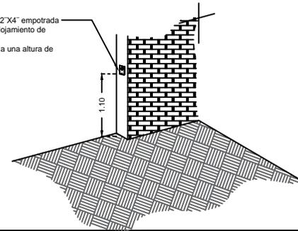
\*Tubería y registro eléctricos suministrados por el cliente, únicamente ductería sin cableado ( DEJAR GUIA EN LA CANALIZACION)
