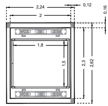
**NOTA:**-EL HUECO DEL ELEVADOR DEBERÁ ESTAR A PLOMO EN LAS DOS ESTACIONES, SIENDO EN ESTE CASO EL FOSO DE 2.00M X 2.30M, MAS LA ESTRUCTURA 2.24M X 2.62M
