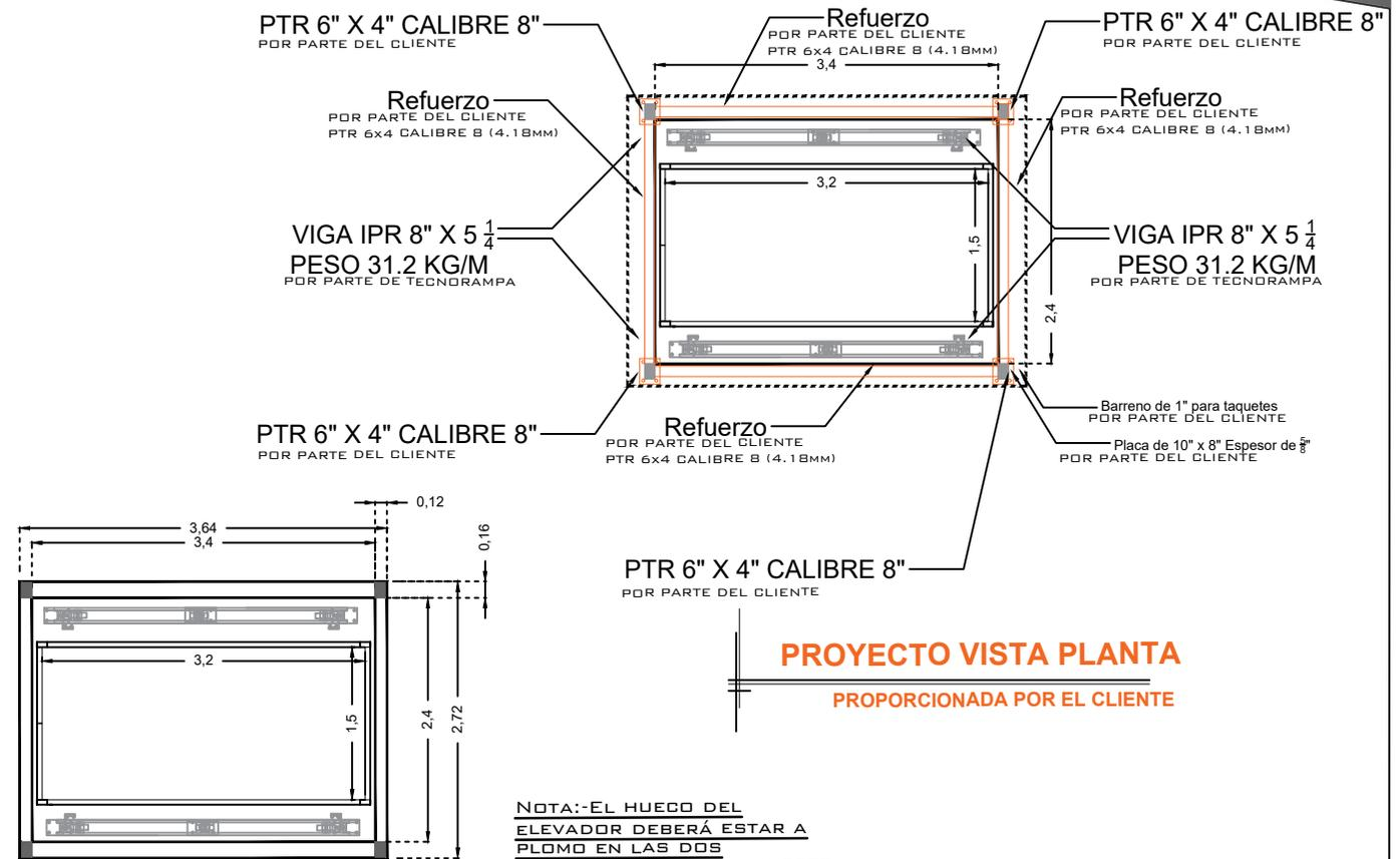
NOTA: -EL HUECO DEL ELEVADOR DEBERÁ ESTAR A PLOMO EN LAS DOS ESTACIONES, SIENDO EN ESTE CASO EL FOSO DE 3.40M X 2.40M MAS ESTRUCTURA 3.64M X 2.72M
