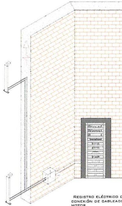
LA DISTANCIA "B" SE CUBRIRÁ DE SER POSIBLE CON DUCTOS REALIZADOS CON TUBERÍA Y LA SALIDA EN EL FOSO SERÁ RECOMENDABLE UBICARLA DEL LADO DONDE SE ENCONTRARAN LAS COLUMNAS Y EL RESTO DE LA ESTRUCTURA DEL ELEVADOR. EN CASO DE QUE NO SE PUEDA INSTALAR ESTOS DUCTOS SE EMPLEARA UNA CANALIZACIÓN DIFERENTE QUE PROTEJA EL CABLEADO. EN CUALQUIERA DE LOS DOS CASOS ESTÁ SERÁ SUMINISTRADA POR PARTE DE TECNORAMPA Y LOS TRABAJOS PARA SU INSTALACIÓN LO HARÁ EL EQUIPO DE LA EMPRESA.
