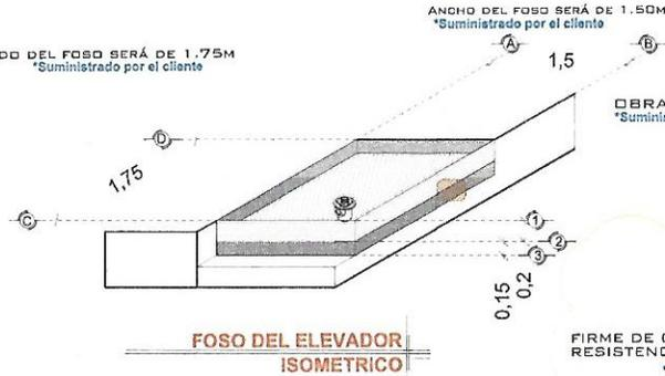
OBRA CIVIL PARA EL ANCLAJE DEL EQUIPO
