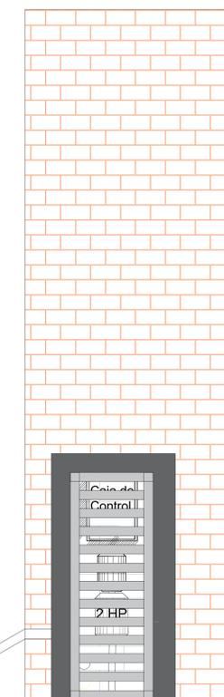
NOTA: POR CADA NIVEL ADICIONAL DEBERÁ DE COLOCAR UNA CHALUPA PARA ALOJAR EL BOTÓN DE LLAMADO Y DEBERÍA DE CONTINUAR LA TUBERÍA HASTA ESTA. SE SOLICITA ESTA PREPARACIÓN PARA QUE LA CANALIZACIÓN QUEDA OCULTA Y LAS BOTONERAS EMPOTRADAS.
