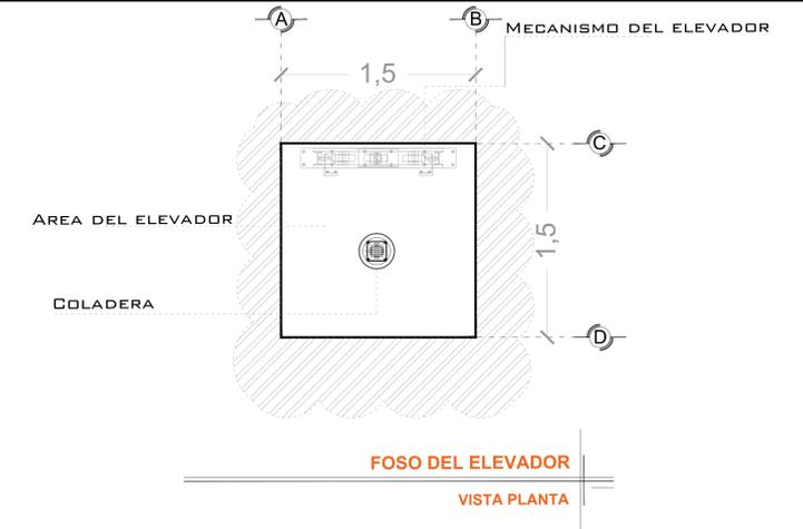
POR MOTIVO DE SEGURIDAD ANTE POSIBLES ACUMULACIONES DE AGUA, COMO INUNDACIONES O FUGAS, SE RECOMIENDA LA INSTALACIÓN UNA SALIDA DE TUBERÍA DE DRENAJE (COLADERA) PARA DESALOJAR EL AGUA QUE SE PUDIERA ALMACENAR EN EL FOSO, DICHA TUBERÍA SE CONECTARA A LA RED DE DRENAJE O ÁREAS VERDES SEGÚN LA DECISIÓN DEL CLIENTE.
