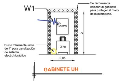
Alimentación bifásica a 220 V, con neutro y tierra física, con break termomagnético de protección 2x30 A libres de consumo
