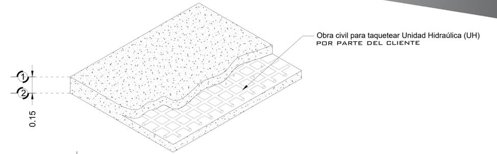
**ARMADO DE FIRME PARA UNIDAD HIDRAULICA**
