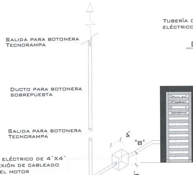
LA DISTANCIA "B" SE CUBRIRÁ DE SER POSIBLE CON DUCTOS REALIZADOS CON TUBERÍA Y LA SALIDA EN EL FOSO SERÁ RECOMENDABLE UBICARLA DEL LADO DONDE SE ENCONTRARAN LAS COLUMNAS Y EL RESTO DE LA ESTRUCTURA DEL ELEVADOR. EN CASO DE QUE NO SE PUEDA INSTALAR ESTOS DUCTOS SE EMPLEARA UNA CANALIZACIÓN DIFERENTE QUE PROTEJA EL CABLEADO. EN CUALQUIERA DE LOS DOS CASOS ESTÁ SERÁ SUMINISTRADA POR PARTE DE TECNORAMPA Y LOS TRABAJOS PARA SU INSTALACIÓN LO HARÁ EL EQUIPO DE LA EMPRESA.
