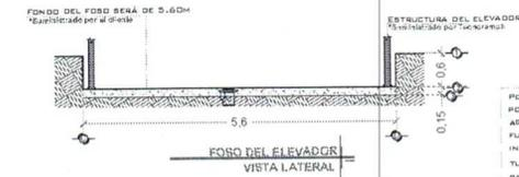
POB MOTIVO DE SEGURIDAD ANTE POSIBLES ACUMULACIONES DE AGUA, COMO INUNDACIONES O FUGAS, SE RECOMIENDA LA INSTALACIÓN UNA SALIDA DE TUBERÍA DE DRENAJE (COLADERA) PARA DESALZAR EL AGUA QUE SE PUEDERA ALMACENAR EN EL FOSO, DICHA TUBERÍA SE CONECTARA A LA RED DE DRENAJE O ÁREAS VERDES SEGUN LA DECISION DEL CLIENTE.
