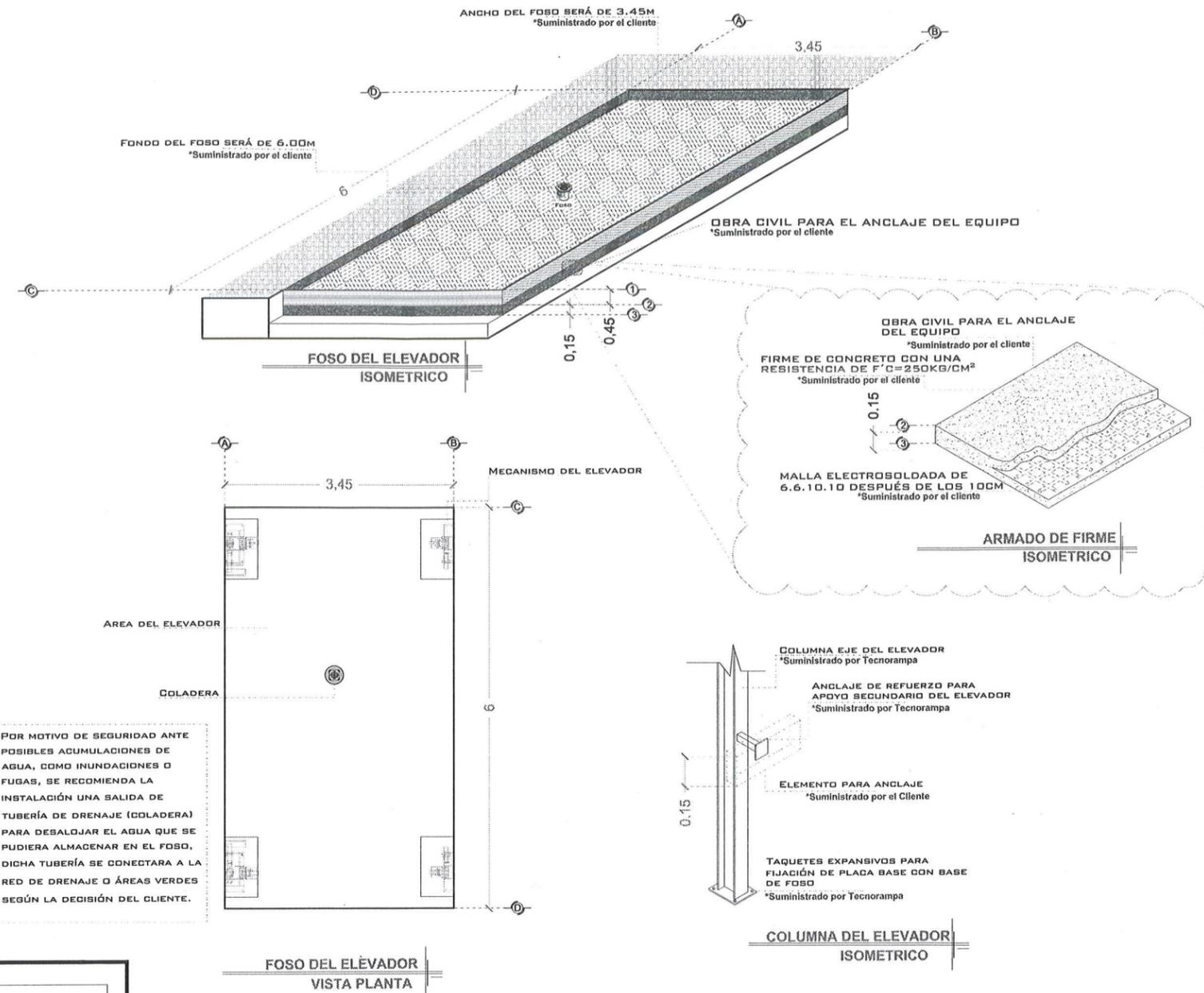
POR MOTIVO DE SEGURIDAD ANTE POSIBLES ACUMULACIONES DE AGUA, COMO INUNDACIONES O FUGAS, SE RECOMIENDA LA INSTALACIÓN UNA SALIDA DE TUBERÍA DE DRENAJE (COLADERA) PARA DESALOJAR EL AGUA QUE SE PUDIERA ALMACENAR EN EL FOSO. DICHA TUBERÍA SE CONECTARA A LA RED DE DRENAJE O ÁREAS VERDES SEGÚN LA DECISIÓN DEL CLIENTE.
