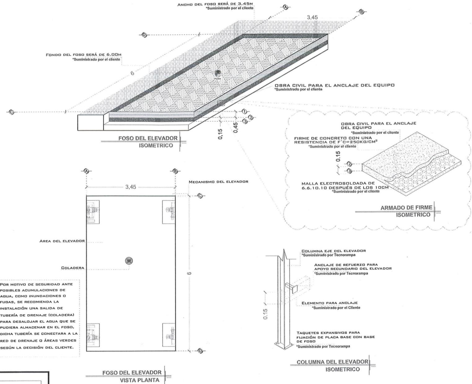
POR MOTIVO DE SEGURIDAD ANTE POSIBLES ACUMULACIONES DE AGUA, COMO INUNDACIONES O FUGAS, SE RECOMIENDA LA INSTALACIÓN UNA SALIDA DE TUBERÍA DE DRENAJE (COLADERA) PARA DESALDAR EL AGUA QUE SE PUDIERA ALMACENAR EN EL FOSO, DICHA TUBERÍA SE CONECTARA A LA RED DE DRENAJE O ÁREAS VERDES SEGÚN LA DECISIÓN DEL CLIENTE.
