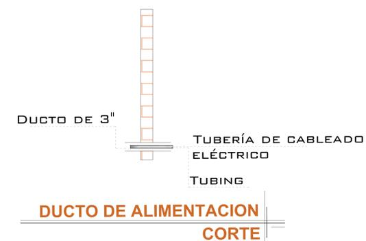
LA DISTANCIA "B" SE CUBRIRÁ DE SER POSIBLE CON DUCTOS REALIZADOS CON TUBERÍA Y LA SALIDA EN EL FOSO SERÁ RECOMENDABLE UBICARLA DEL LADO DONDE SE ENCONTRARÁN LAS COLUMNAS Y EL RESTO DE LA ESTRUCTURA DEL ELEVADOR. EN CASO DE QUE NO SE PUEDA INSTALAR ESTOS DUCTOS SE EMPLEARÁ UNA CANALIZACIÓN DIFERENTE QUE PROTEJA EL CABLEADO. EN CUALQUIERA DE LOS DOS CASOS ESTÁ SERÁ SUMINISTRADA POR PARTE DE TECNORAMPA Y LOS TRABAJOS PARA SU INSTALACIÓN LO HARÁ EL EQUIPO DE LA EMPRESA.
