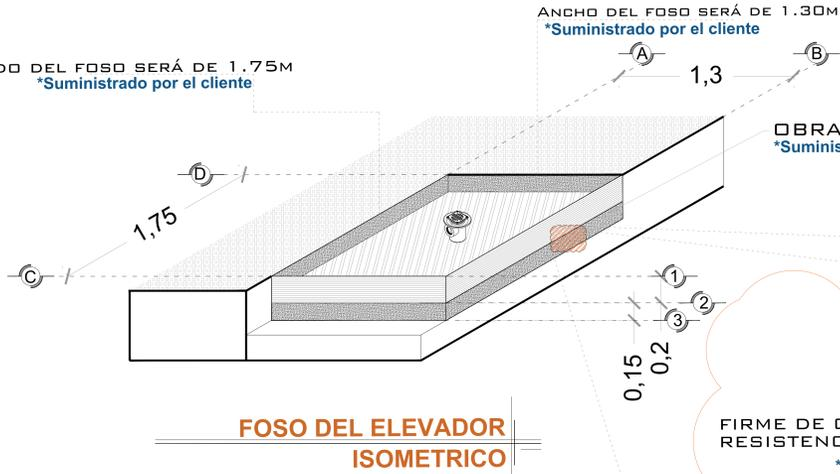
OBRA CIVIL PARA EL ANCLAJE DEL EQUIPO
