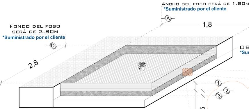
OBRA CIVIL PARA EL ANCLAJE DEL EQUIPO
