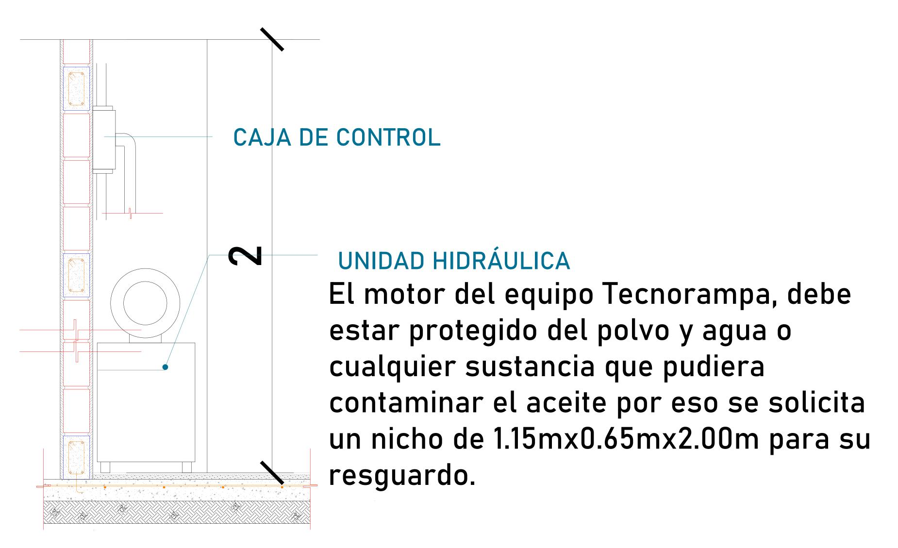
El cliente suministra, instala y energiza centro de carga con alimentación trifásica a 220V, con neutro y tierra física, e interruptor termomagnético de 3 x 50 Amp exclusivo para el elevador, deberá colocarse en el área donde se ubique la unidad hidráulica y control eléctrico proporcionado por TECNORAMPA a no mayor de 5.00m del área del equipo.
