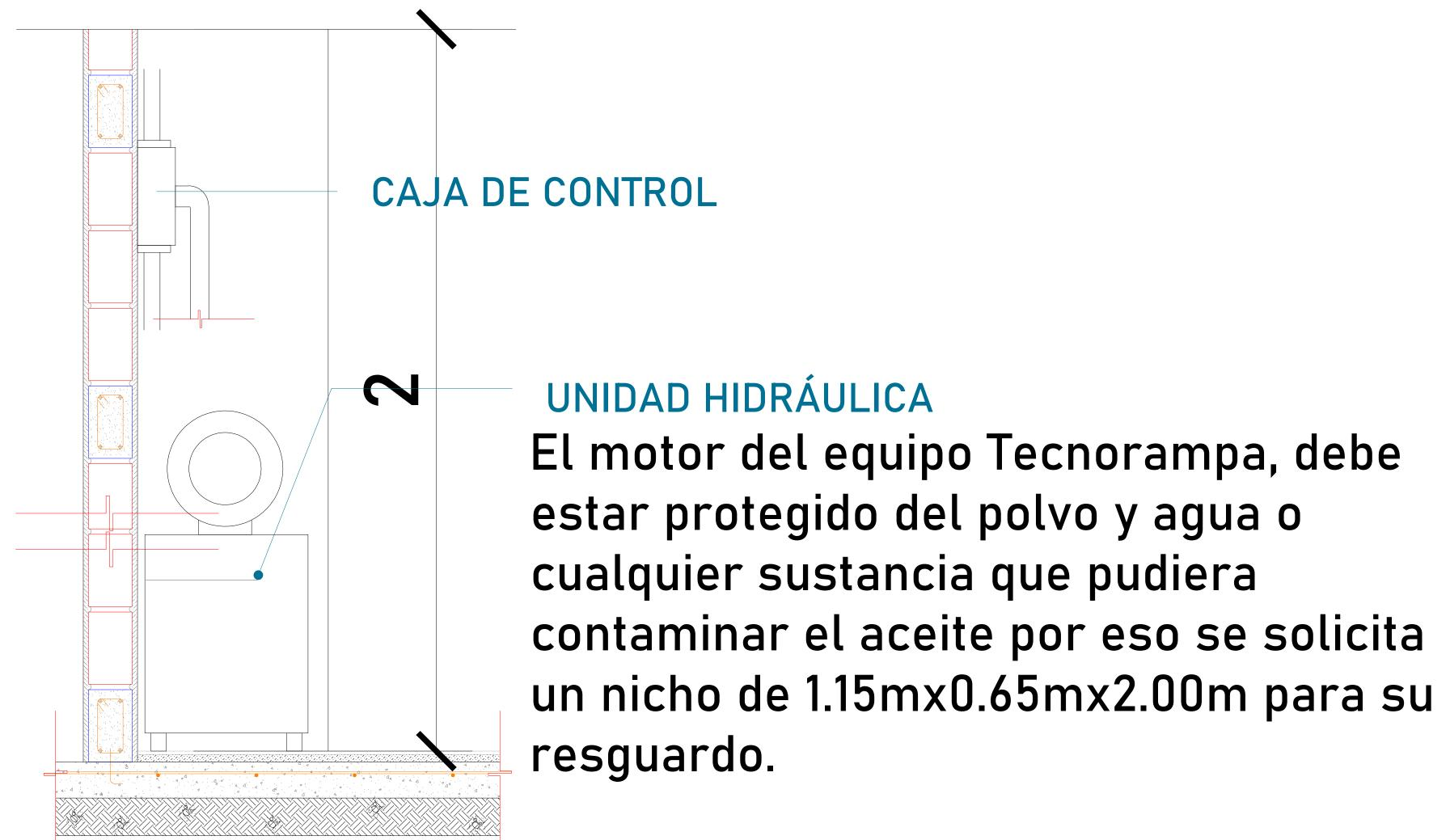
El cliente suministra, instala y energiza centro de carga con alimentación trifásica a 220V, con neutro y tierra física, e interruptor termomagnético exclusivo para el elevador, deberá colocarse en el área donde se ubique la unidad hidráulica y control eléctrico proporcionado por TECNORAMPA a no mayor de 5.00m del área del equipo.
