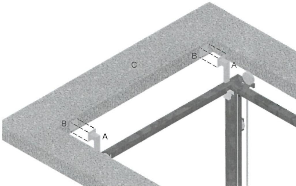
**NOTA:** Debido a que el muro deberá de soportar y dar firmeza a la estructura del elevador será necesario que este sea capaz de soportar dicha carga, por lo que se requiere que el área donde se coloquen los soportes sea de concreto, ya que si el muro completo no es de concreto, el área de conexión deberá de serlo empleándose para ello una trabe o cadena de cerramiento reforzada.
