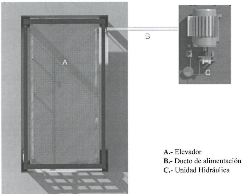
**NOTA:** La distancia B se cubrirá de ser posible con ductos realizados con tubería, y la salida en el foso será recomendable ubicarla del lado donde se encontraran las columnas y el resto de la estructura del elevador. En caso de que no se pueda instalar estos ductos se empleara una canalización diferente que proteja el cableado. En cualquiera de los dos casos esta será suministrada por parte de Tecno Rampa, y los trabajos para su instalación lo hará el equipo de la empresa.
