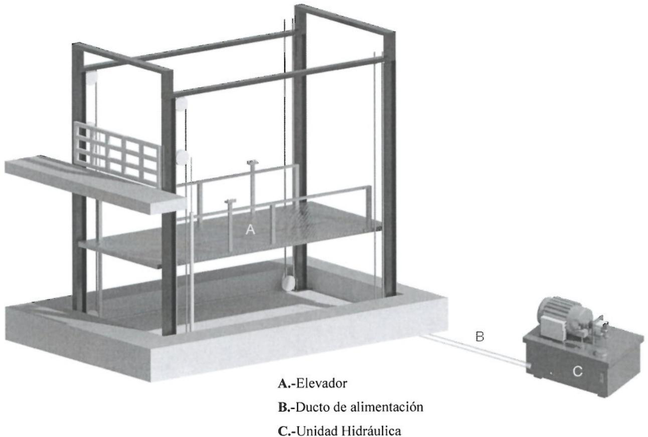
La unidad hidráulica y control eléctrico deberán ser instalados fuera del foso y ubicarse en un lugar libre de polvo, líquidos e inclemencias del clima, evitando que se contamine el aceite y se pierda la garantía del equipo.
