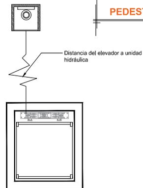
**NOTA:** Por cada nivel adicional deberá de colocar una chalupa para alojar el botón de llamado y debería de continuar la tubería hasta esta.
