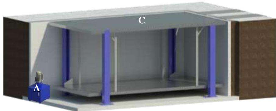
La unidad hidráulica y control eléctrico deberán ser instalados fuera del foso y ubicarse en un lugar libre de polvo, líquidos e inclemencias del clima, evitando que se contamine el aceite y se pierda la garantía del equipo.
