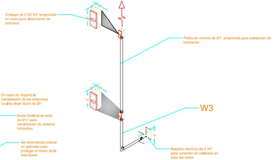
\*Tubería y registro eléctricos suministrados por el cliente, únicamente ductería sin cableado (DEJAR GUIADA CANALIZACION)
