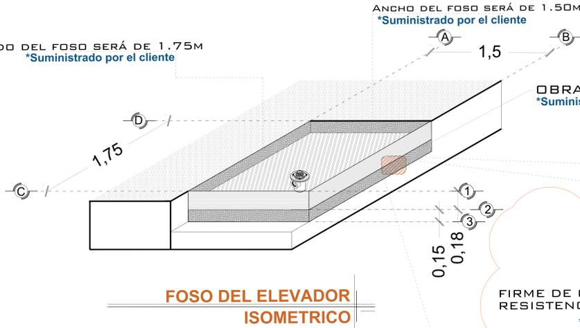
OBRA CIVIL PARA EL ANCLAJE DEL EQUIPO
