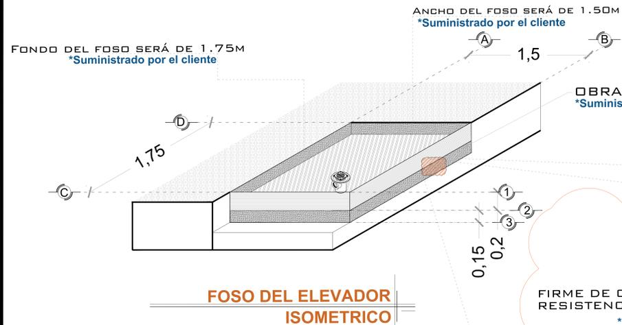
OBRA CIVIL PARA EL ANCLAJE DEL EQUIPO
