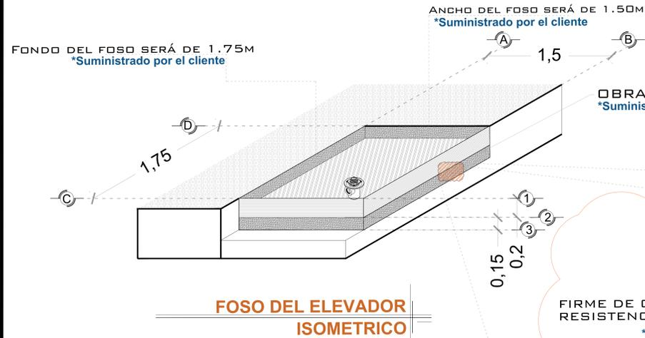
OBRA CIVIL PARA EL ANCLAJE DEL EQUIPO
