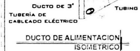
LA DISTANCIA "B" SE CUBRIRÁ DE SER POSIBLE CON DUCTOS REALIZADOS CON TUBERÍA Y LA SALIDA EN EL FOSO SERÁ RECOMENDABLE UBICARLA DEL LADO DONDE SE ENCONTRARÁN LAS COLUMNAS Y EL RESTO DE LA ESTRUCTURA DEL ELEVADOR. EN CASO DE QUE NO SE PUEDA INSTALAR ESTOS DUCTOS SE EMPLEARÁ UNA CANALIZACIÓN DIFERENTE QUE PROTEJA EL CABLEADO. EN CUALQUIERA DE LOS DOS CASOS ESTÁ SERÁ SUMINISTRADA POR PARTE DE TECNORAMPA Y LOS TRABAJOS PARA SU INSTALACIÓN LO HARÁ EL EQUIPO DE LA EMPRESA.
